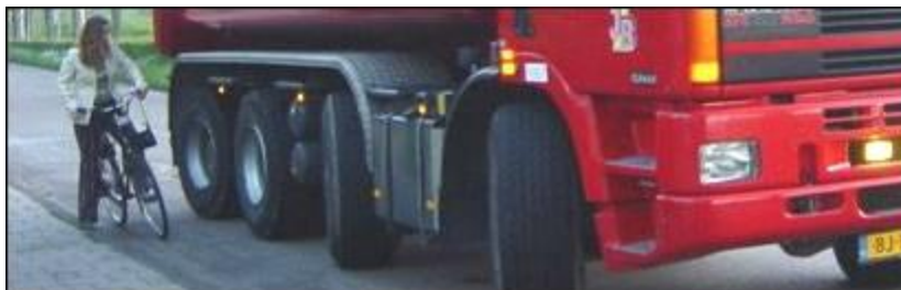
Exemple de cycliste se trouvant dans l'angle mort d'un poids lourds (Source : lisa2alert.com)
