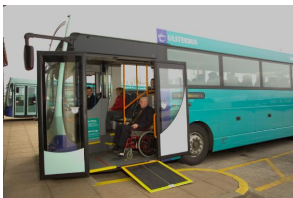
Exemple de rampe surbaissée pour permettre aux handicapés l'accès au bus, source : Wright bus
